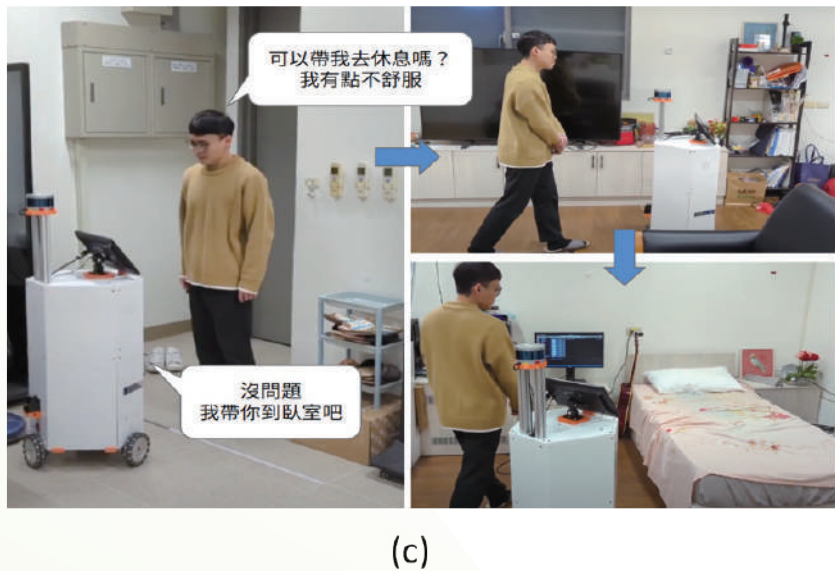
機器人透過語音理解其意圖，並將人們帶到其想去的地方。(a) 模擬居家環境的實驗場域；(b) 居家環境的平面圖；(c) Dave 與機器人OREO的互動狀況。
