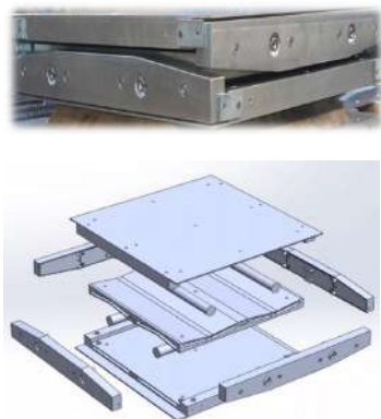
(a) 隔震支承外觀與結構
