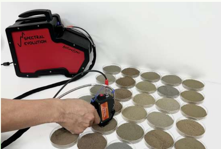
圖5：筆者研究團隊透過可見-近紅外光譜儀開發快速進行非破壞性的土壤有機碳檢測技術。
