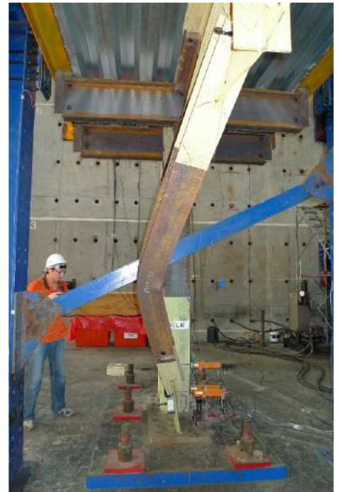
圖4：實尺寸同心斜撐構架抗震實驗受壓斜撐面外挫屈情形
