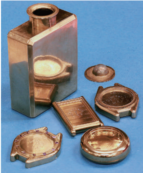
圖5：以吹塑法製造出成形的金屬玻璃製品，其形貌及一體成型複雜的細微結構對於一般金屬很難做到 [4] 。
