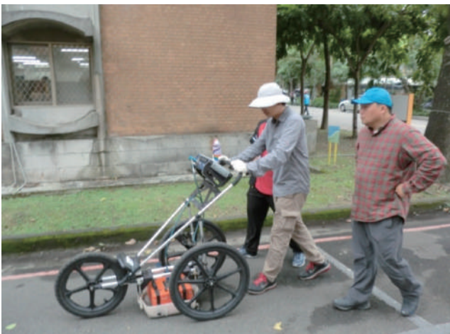
透地雷達探測工作照片。 (資料來源：本校透地雷達探測作業報告)
