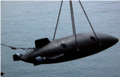
圖3：自主式水下載具，長2公尺、寬1公尺、高0.6公尺。最大航速6節，潛深300公尺，航行時間6小時。
