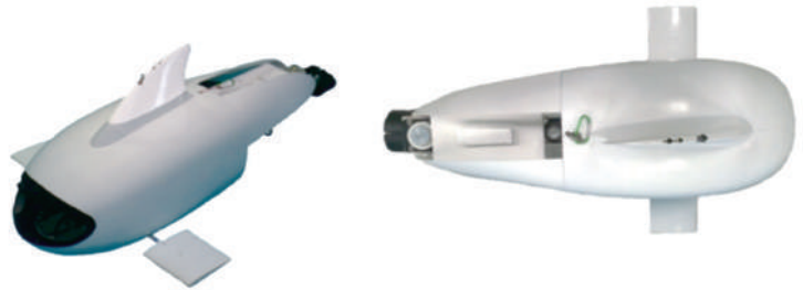
圖4：強力迴旋載具的側視（左）及俯視（右）圖。長90公分，重19.5公斤。使用艏旋螺槳與胸鰭剎車做高速迴轉，其迴旋半徑在航速每秒1公尺時為30公分。
