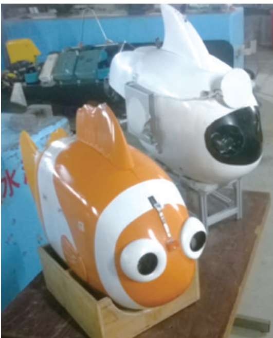
圖5：配備壓力感測皮膚（左圖橘色）及光通訊器（左圖白色）的水下載具。右圖為裝置於船底或吊掛於水面浮球下的光通訊節點，載具與此節點通訊則可經由此節點與衛星連線。
