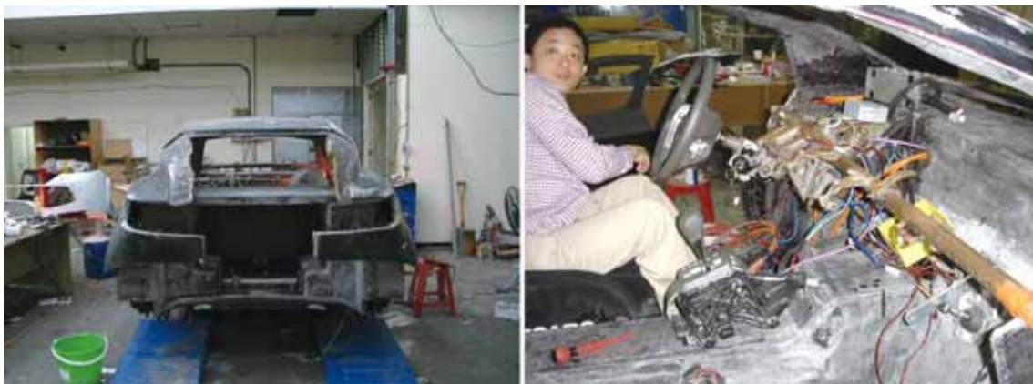
圖6：全車組裝與複雜之線路安裝。
