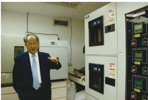
實驗室有畫線機、色差機、粒徑分析儀等設施，宛如小型化工廠，藉由模擬高熱、潮濕、溫度極端變化等惡劣情境，製造可適應不同氣候條件的同款產品。（攝影／彭玉婷）
