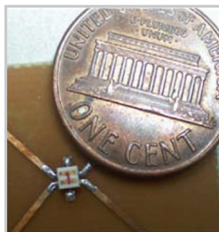
圖4：實現於LTCC上的縮小化寬頻的共模濾波器，比例頻寬為120% (4 GHz)，大小為1.6mm平方。(發表於2010年1月IEEE T-MTT)
