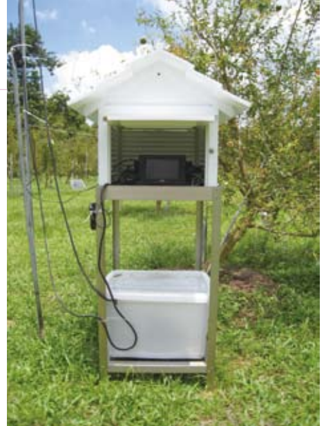
圖1：東方果實蠅生態監測田間閘道器—以筆記型電腦為核心。
