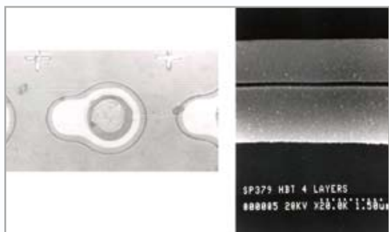
早期HBT磊晶結構的電子顯微鏡照片與顯微鏡照片（1985）。
