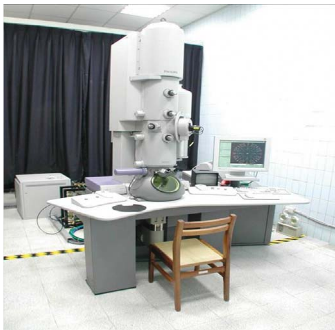
會 工學院新購貴儀之一：材料系場發射穿透式電子顯微儀。
