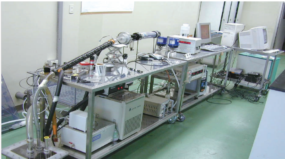
圖1：微粒濃縮器可引進大氣，將微粒濃度濃縮十倍，進行呼吸毒理實驗。
