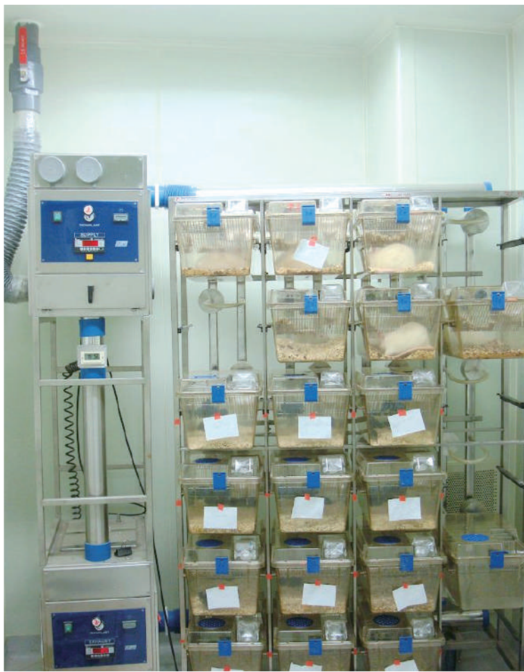
圖2：臺北大氣微粒暴露系統（TAPES），改裝動物飼養籠系統，在氣體入口處加裝微粒過濾網，可進行長期暴露，比較有無微粒暴露的毒性。
