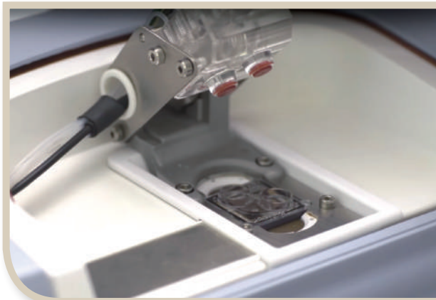
臨床上使用的次世代定序系統，多是以晶片的方式進行。圖為Ion Personal Genome Machine (PGM) 系統。
