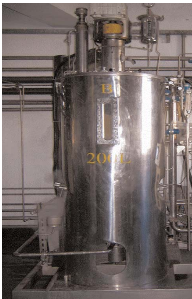
■ 圖 2：靈芝於發酵槽中之液態培養。
