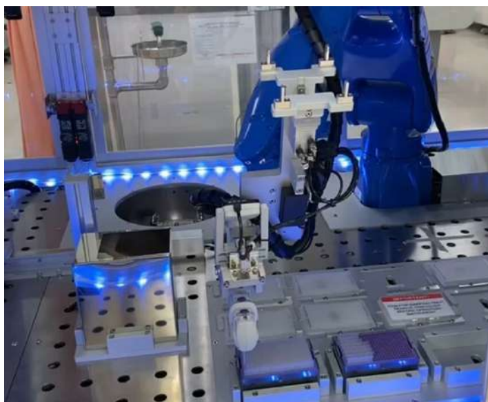
新竹臺大分院生醫醫院6月4日啟用「高通量全自動新型冠狀病毒核酸檢測系統」核酸萃取區之機械手臂執行自動分注試劑。（圖／新竹臺大分院提供）
