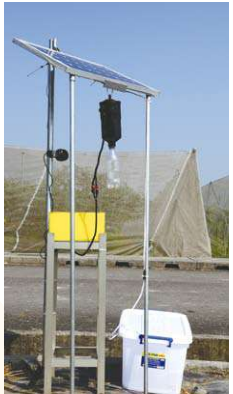
圖2：東方果實蠅生態監測田間閘道器—以微晶片MSP430為核心。
