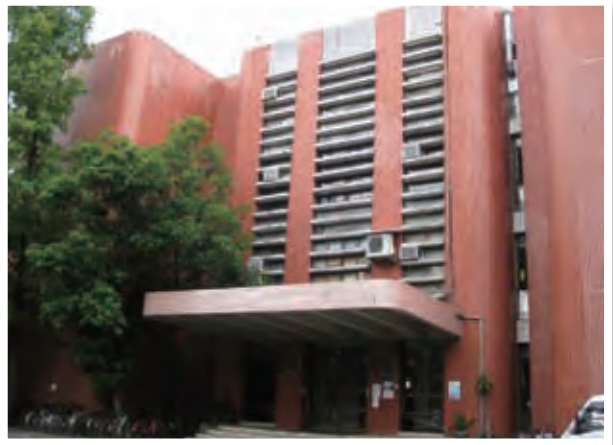
生化所立面採用白色輕巧的水平遮陽隔板，與兩側紅色厚重外牆呈現對比。
