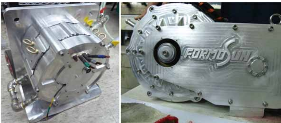
圖2：電動車馬達與傳動齒輪箱。
