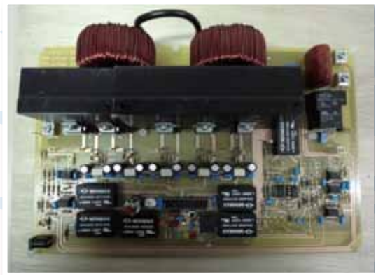
(b) 採用ASDM電流控制之PV Inverter
