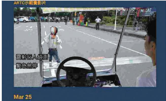
2016年示範自駕高爾夫球車。雷射自動偵測行人緊急煞停。
