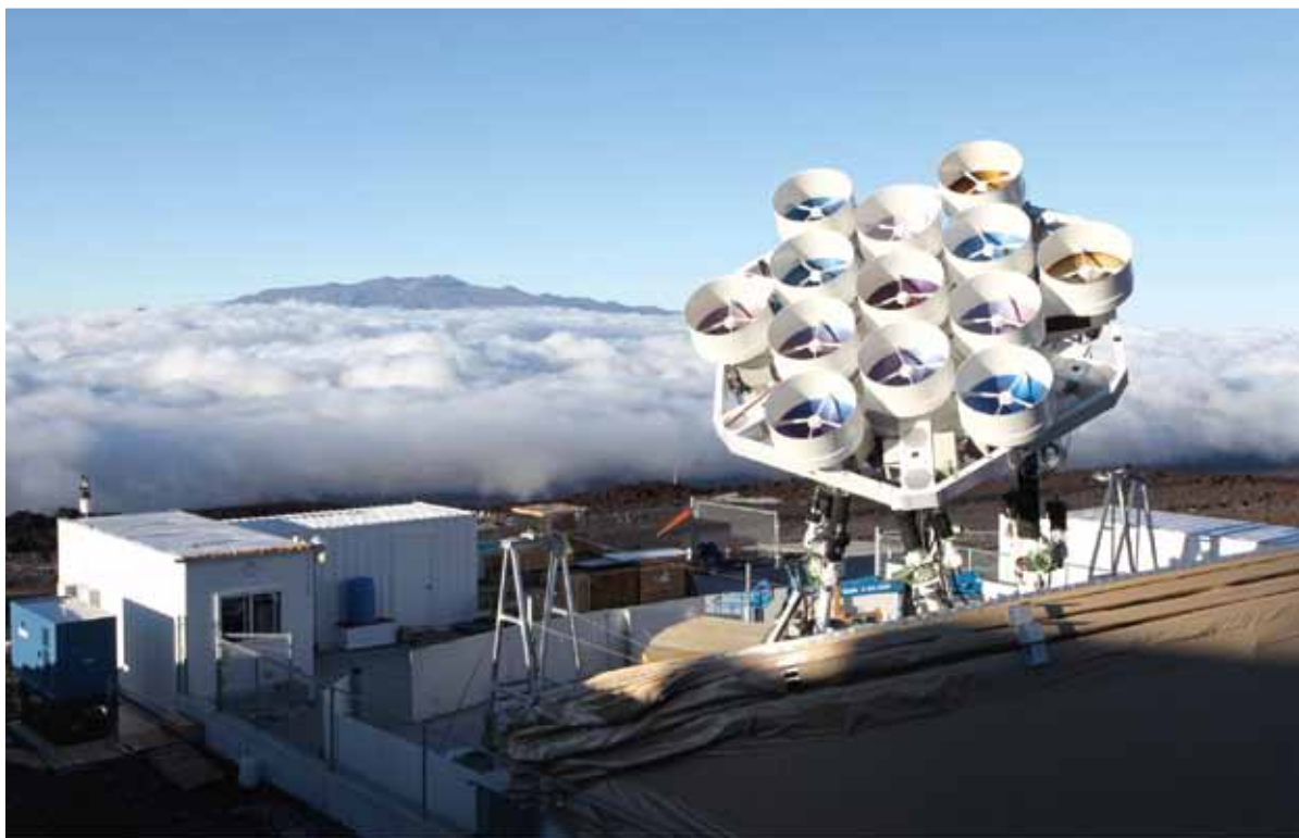
圖2：AMiBA的13天線陣列。平台與基座和圖一相同，天線直徑則增大為1.2米。背景可見同處夏威夷大島的毛納基山。
