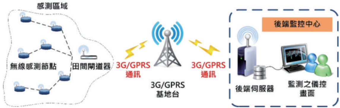
圖3：自動化田間環境參數遠距監測系統。
