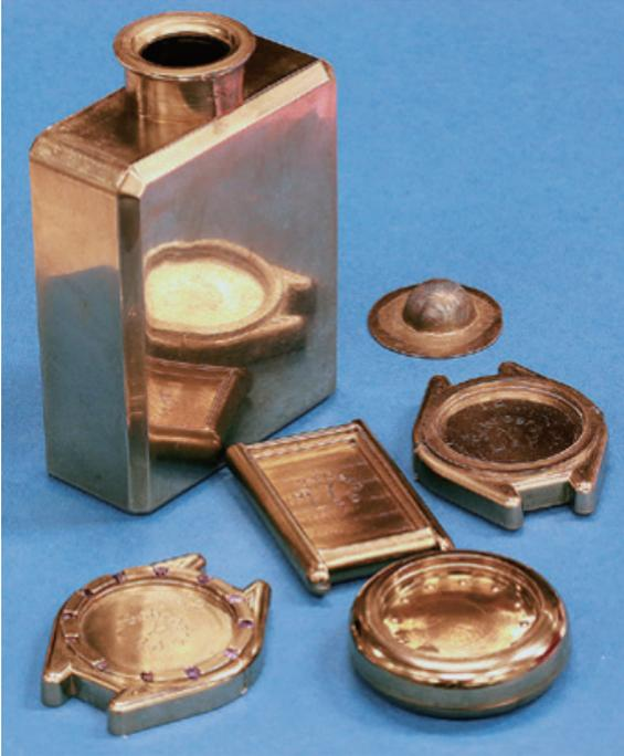
圖5：以吹塑法製造出成形的金屬玻璃製品，其形貌及一體成型複雜的細微結構對於一般金屬很難做到<sup>[4]</sup>。
