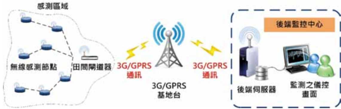
圖3：自動化田間環境參數遠距監測系統。
