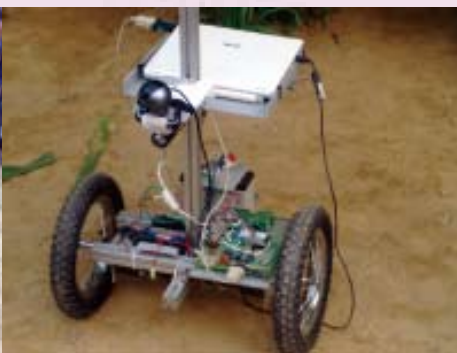
· 臺灣大學生物機電系「嘻嘻哈哈」隊所設計之田間機器人，應用電腦視覺技術作為前進的自動導引。
