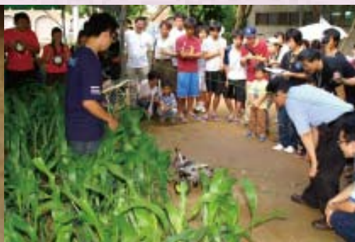
· 田間機器人行走於玉米田賽道，遇彎道自行轉彎。
