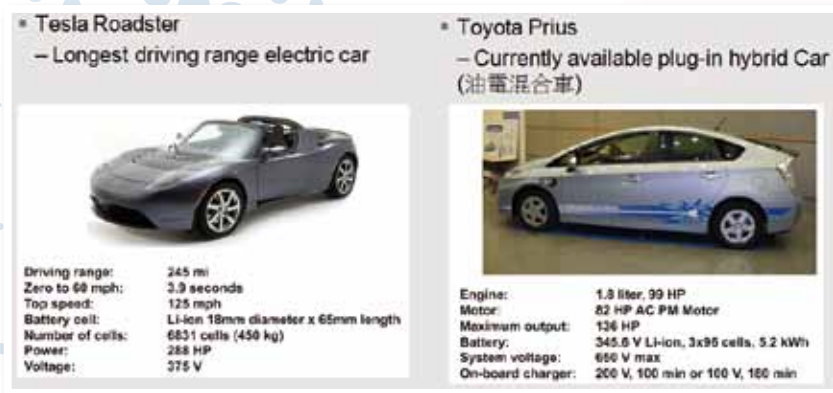
圖3：電動車與油電混合車電源需求
