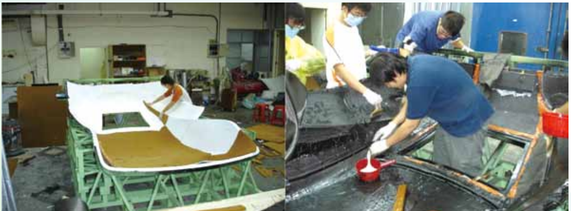
圖5：左邊是車殼的模具，右邊則是學生在上面疊積碳纖維複合材料三明治車殼結構。
