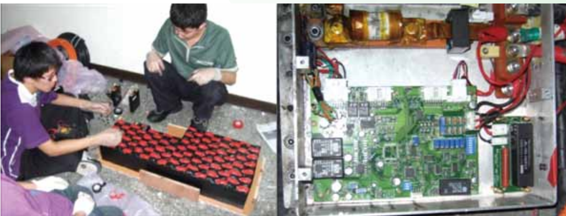
圖3：電池組製作組裝與電池管理系統（BMS）。
