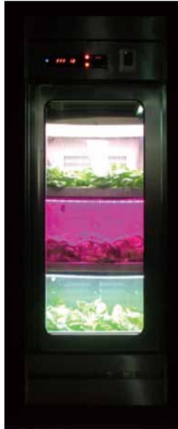
圖6：具備環控功能的家電型植物工廠。
