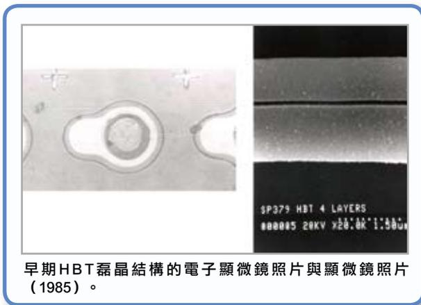
早期HBT磊晶結構的電子顯微鏡照片與顯微鏡照片 (1985)。
